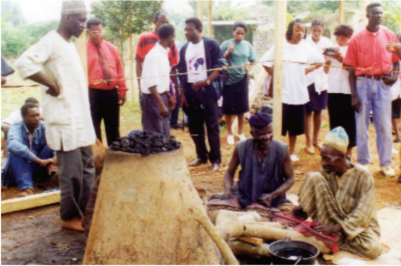
Photo 1 : les fondeurs Nang Hamoa (boubou gris rayé) et Nang Daouda (boubou noir) actionnent les soufflets arrimés à la tuyère pendant la reconstitution d'une opération de réduction de minerai de fer à Yaoundé, le 08 décembre 1997 © Nizésété, 1997.
